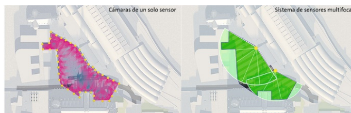
Figura 2. Al contrario de la planificación inicial (izquierda), es posible cubrir con sólo ocho sistemas de sensores multifocales en dos ubicaciones (derecha) toda la superficie de la explanada de la catedral de Colonia.
