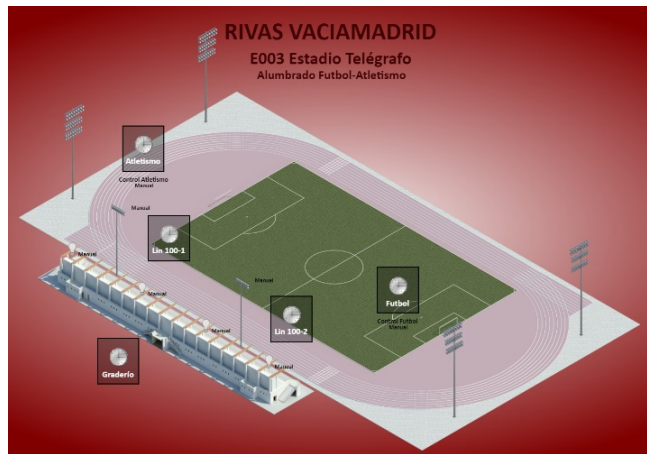
Figura 4. Control horario de alumbrado de instalaciones deportivas.
