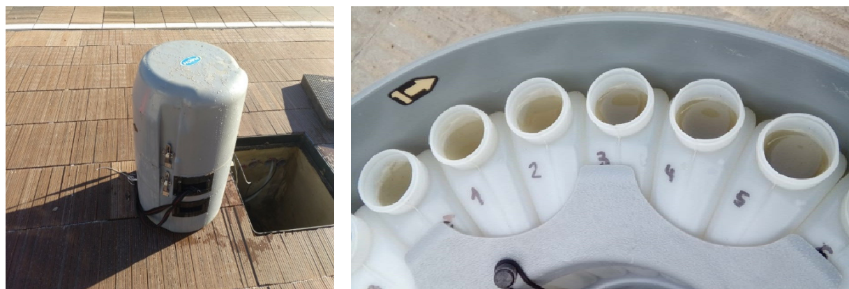
Figura 5. Ejemplo de equipos instalados en el demostrador: (a) tomamuestras automático, (b) botellas tomamuestras.
