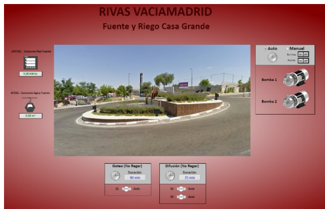
Figura 5. Control horario fuentes y riego.
