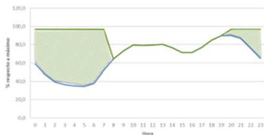
Figura 3. Efecto de la recarga inteligente de vehículo eléctrico sobre la curva de demanda.
