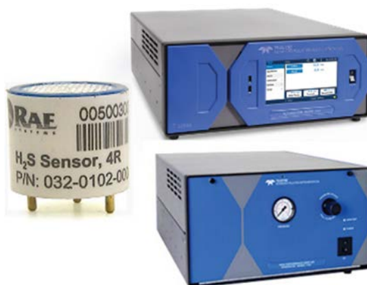
Figura 1. LCS y equipos de instrumentación y calibración de referencia.
