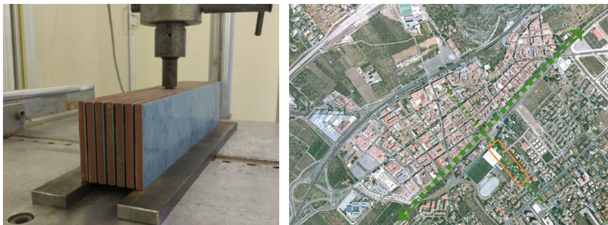
Figura 1. Ejemplo de ensayo de cizalla realizado al sistema cerámico. Figura 2. Vista aérea del casco urbano de Benicàssim (zona de actuación marcada en naranja).
