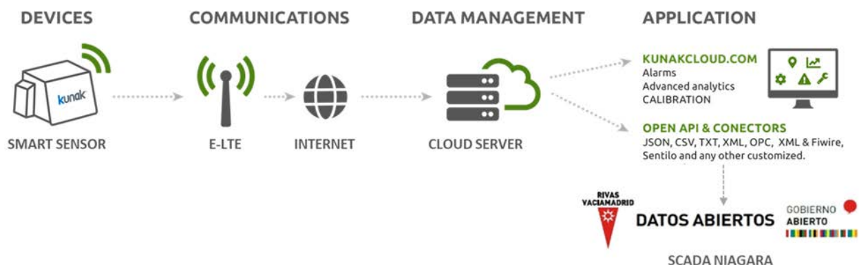
Figura 4. Esquema de comunicaciones de la red de sensores e integración en la vertical de calidad del aire.
