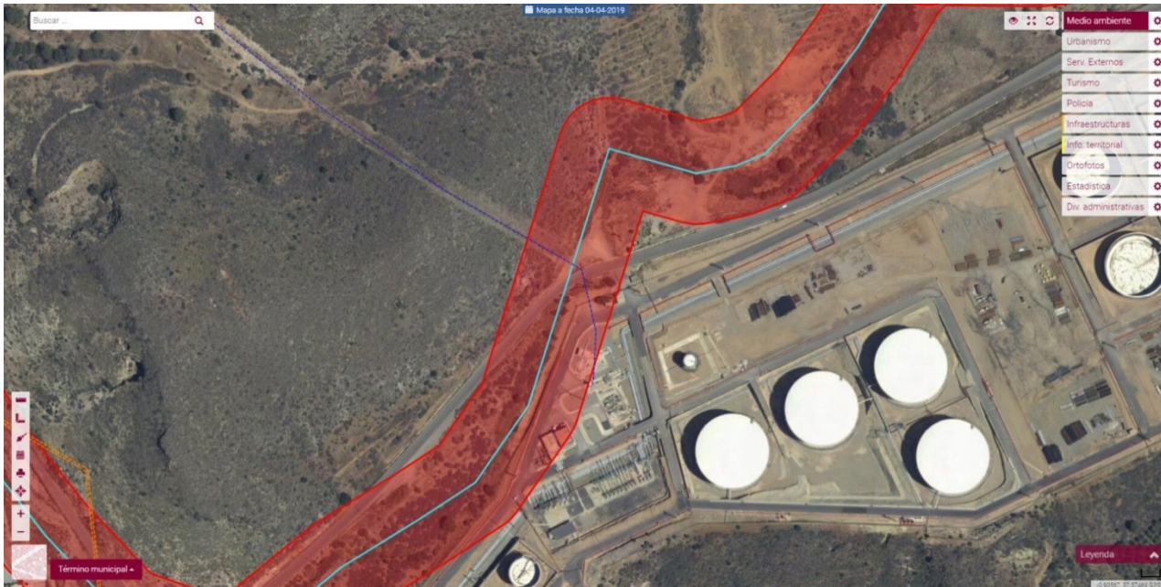
Figura 3. Cálculo de zonas de influencia: Líneas de energía afectadas debido a la cercanía a una rambla.
