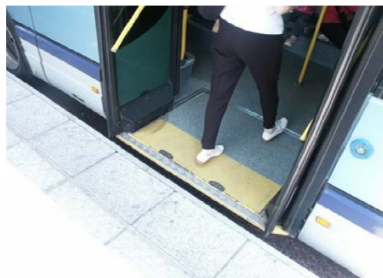
Figura 2. Sistema de guiado óptico y aproximación al andén en el TVRCas.
