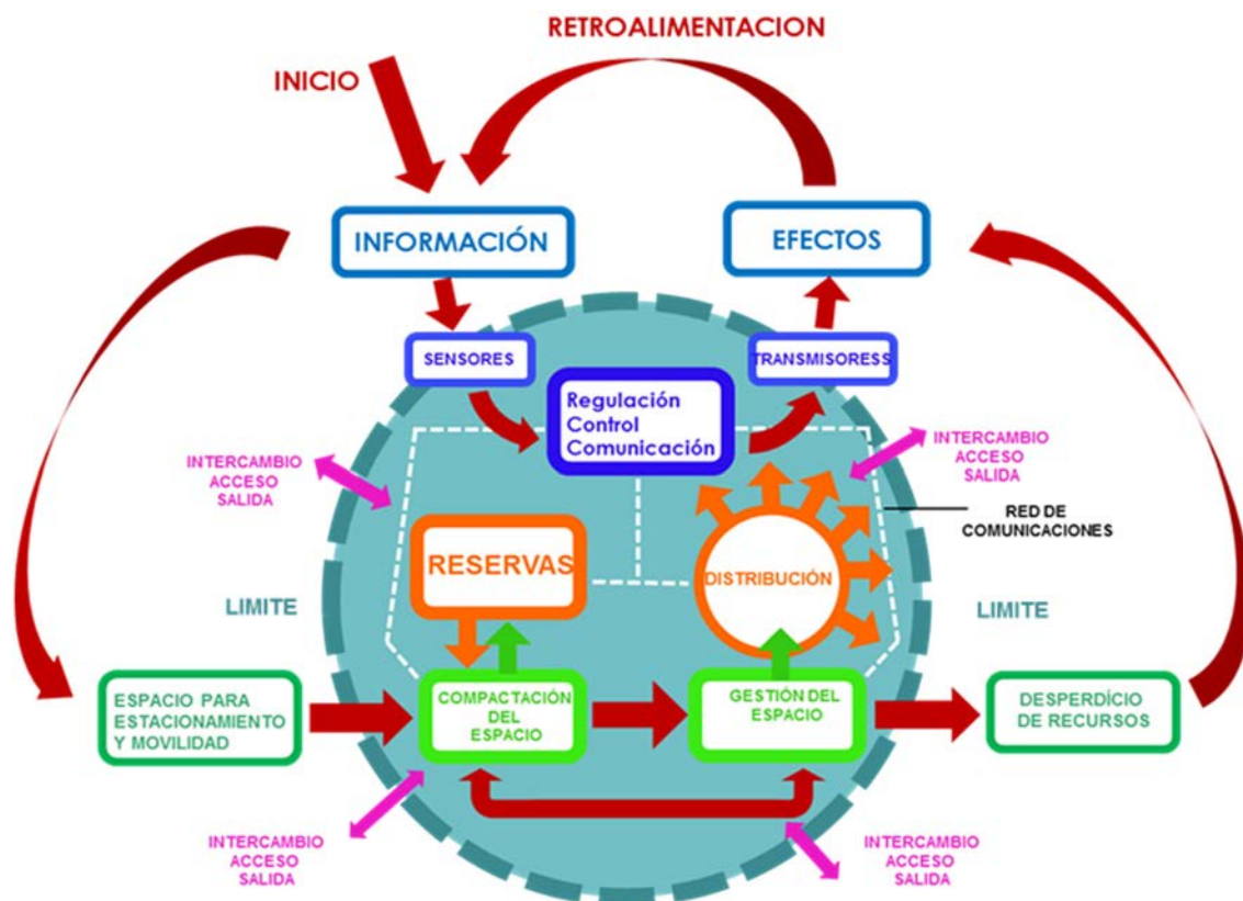
Figura 4. Modelo Sistémico del Aparcamiento Urbano. El sistema se alimenta de dos fuentes de recursos : espacio de aparcamiento e información, a los que se puede agregar servicios energéticos. . La puesta a disposición eficiente de servicios de aparcamiento, multimodales, según distintas fórmulas de uso vehicular, y para distintos usuarios, se consigue mediante la retroalimentación, on-line y en tiempo real, de información que procede de los usuarios, de los operadores, de los gestores, de los explotadores y de los controladores y reguladores de movilidad. Las tecnologías mecánicas de última generación tienen embebida la capacidad de recogida de datos y comunicación, y además las capacidades de compactar, reservar y distribuir el espacio de aparcamiento , que son fundamentales para conseguir el grado superior de eficiencia que requiere una ciudad inteligente.
